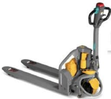
Jungheinrich Transpaleta eléctrica - iones de litio AME 13, capacidad de carga 1.300 kg
